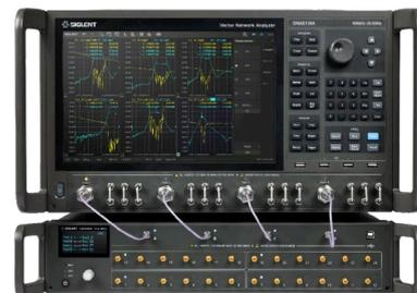
マルチポート・デバイスの試験配線を容易にし、信号の流れを制御する自動試験システムです。周波数範囲9kHz~26.5GHzのSSM5000Aシリーズは、1台で24出力ポートまで拡張可能です。従来の測定方法に比べ、測定速度が大幅に向上し、ベクトルネットワークアナライザとマルチポートDUTの接続とテストを容易にします。
