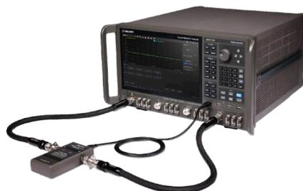
校正ステップ数を大幅に削減し、コネクタの損失を低減します。これにより校正に必要な時間を大幅に短縮し、マルチポート試験や生産ライン試験の利便性を向上します。
